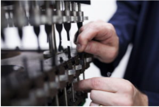
多工位、多应变拉伸疲劳寿命试验
